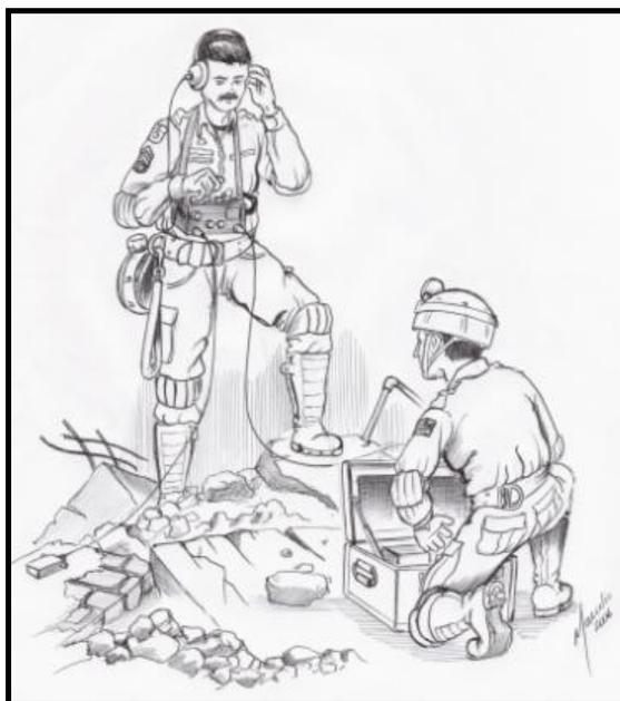
Figura 12.7.3.2.a - Equipe utilizando geofone
