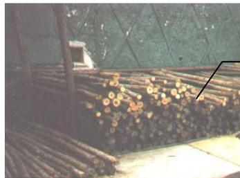
Pontaletes de eucalipto / comprimento 3 à 6 m
