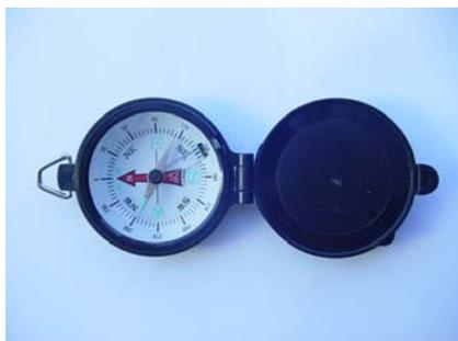
Figura 11.2. Bússola de Limbo Fixo
