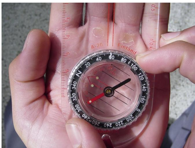
Figura 11.6. Inserindo novo azimute
