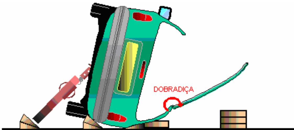
Figura 6.54. Rebatimento lateral com apoio em calço
