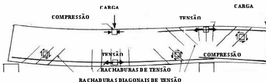
Figura 8.5. Viga de concreto
