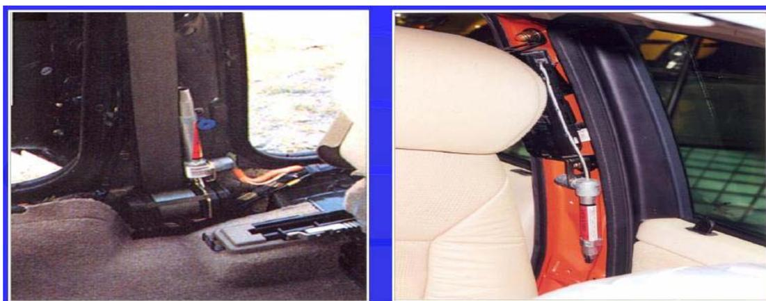
Figura 6.24. Cilindro de gás do pré-tensionador de cinto
