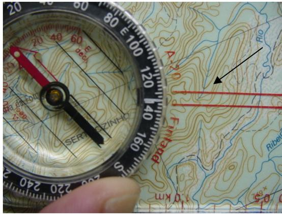
Figura 11.11. Aferição do azimute
