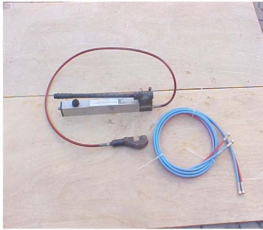
Figura 6.12. Bomba manual e cortador de pedal
