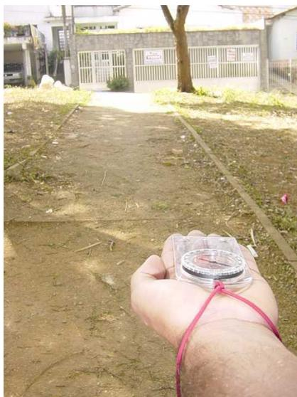
Figura 11.7. Alinhamento do ponto de destino com a bússola e o operador
