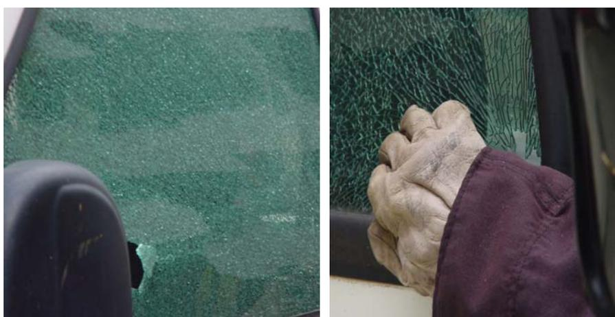
Figura 6.17. Entrada forçada em vidro temperado
